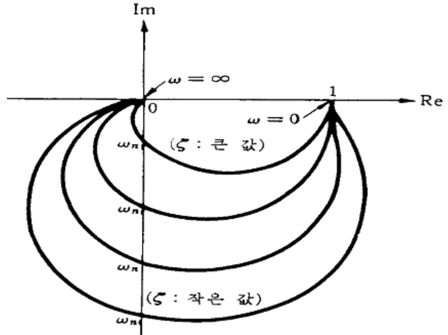
그림 5.17  $\frac{1}{1+2\zeta(j\omega/\omega_n)+(j\omega/\omega_n)^2}$  의 극좌표선도
