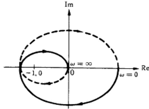
(d)  $G(s) = \frac{K}{(1+T_1s)(1+T_2s)(1+T_3s)}$  ;
