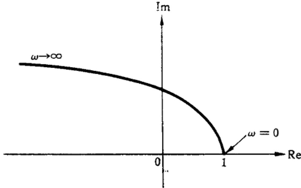
그림 5.18  $1 + 2\zeta(j\omega / \omega_n) + (j\omega / \omega_n)^2$  의 극좌표선도
