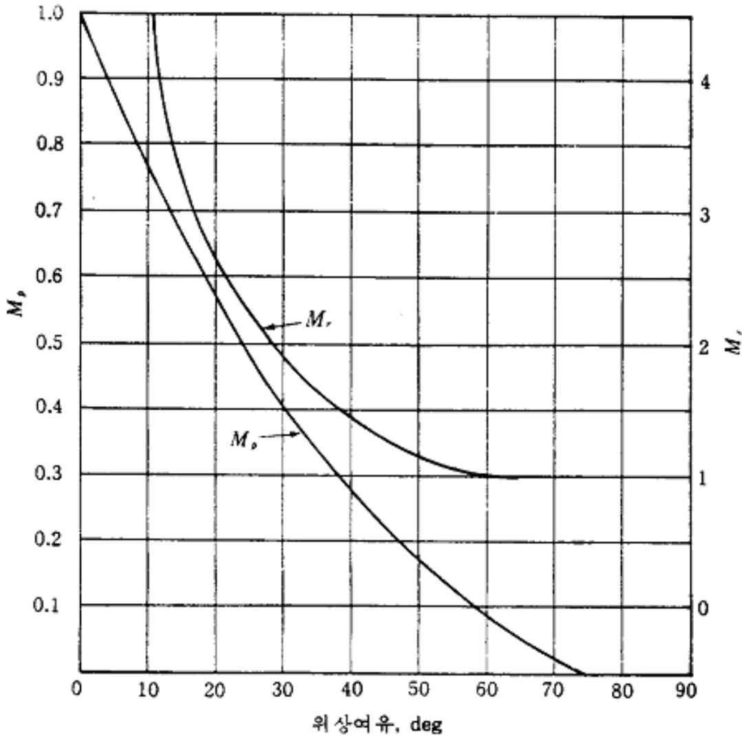
그림 5.38 2차 시스템의 위상여유  $\gamma$ 값에 따른
