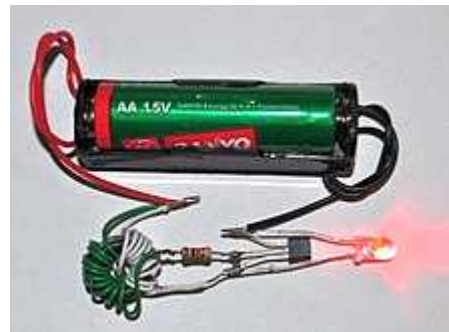
그림 1. 적색 LED, 페라이트 코어에 두 코일을 감고, 2N2222A TR과 1000Ω의 저항을 사용한 줄도둑 회로의 예.
